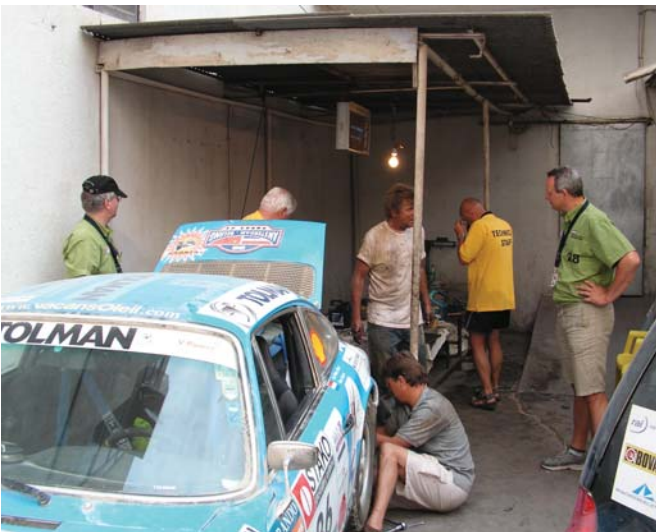
Een Porsche met een tik in de motor betekende voor het service-team een nachtje 'doorhalen'. De uiteindelijke oorzaak bleek een losgelaten slangklem te zijn die zijn sporen in de verbrandingsruimte van één van de cilinders had achtergelaten.
