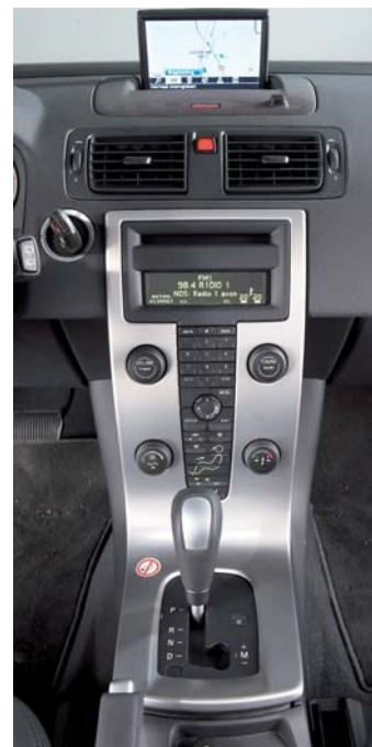
Op de zwevende middenconsole vinden we het audiosysteem, klimaatregeling en navigatie. De laatste is een optie op alle modellen.
