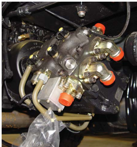
De hydropomp wordt aangedreven door de uitgaande as op de versnellingsbak naar de achterwielaandrijving. Hierdoor zijn de voor- en achteraandrijving gesynchroniseerd.
