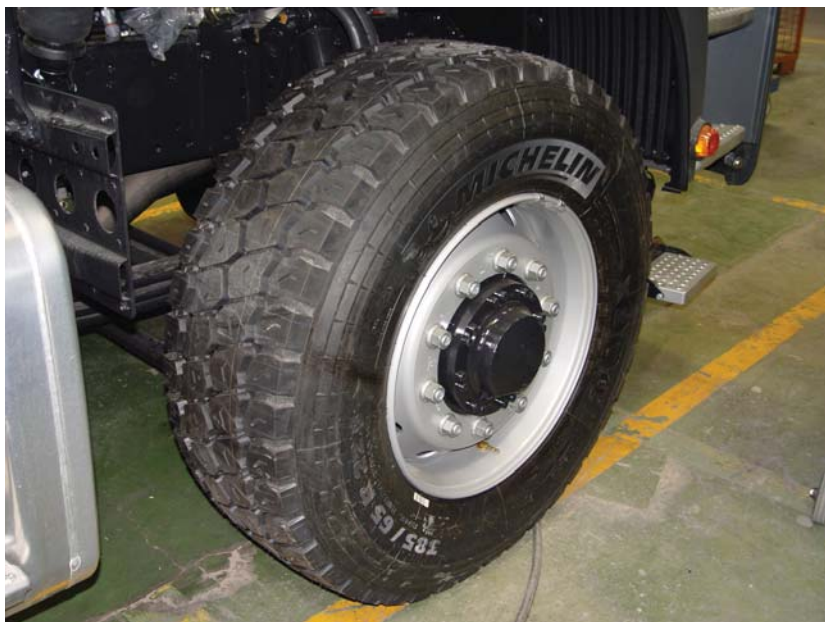
Aan de buitenkant valt nauwelijks te ontdekken dat we te maken hebben met een hydrostatische voorwielaandrijving, de motoren zijn weggewerkt in de naaf. De draaicirkel doet niet onder voor die van een achterwielaangedreven versie.
