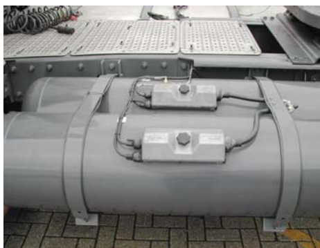
Afhankelijk van het gebruik en de inzet krijgt de Bi-Fuel truck één of meerdere gastanks. Streven is om tweemaal diesel te tanken en eenmaal LPG.
