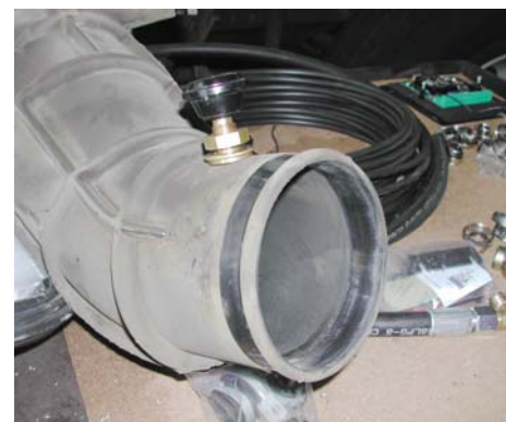
De LPG-toevoer geschiedt via een in de inlaat, voor de blower, aangebrachte injector.
