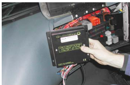
Gasotronic heeft een eigen regelunit ontwikkeld die geheel is te programmeren en is afgestemd op het motormanagement van de truck. Beide regelunits opereren separaat, ze gebruiken wel een aantal zelfde parameters.
