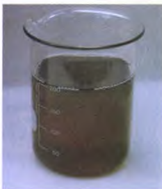
Links ziet u schone diesellole, het is transparant. Als er micro-organismen in de brandstof zitten (rechts), is dat te zien aan het troebel worden.
