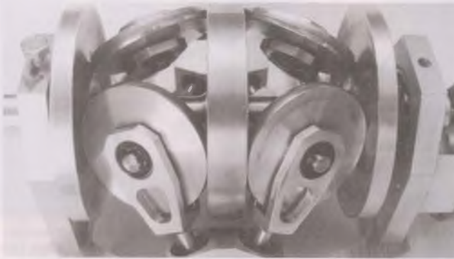
Het hart van de dubbeltorische-schijfvariator van Torotrak. De rollen worden hydraulisch verplaatst, de hoek ten opzichte van de schijven komt automatisch (door reactiekrachten van de schijven) tot stand.
