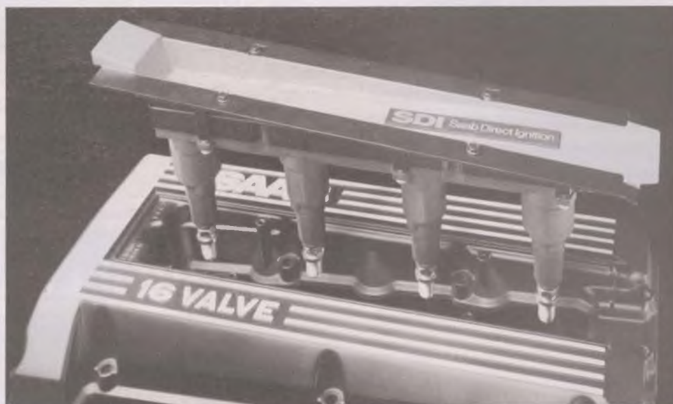
Saab Direct Ignition systeem met één bobine per cilinder
