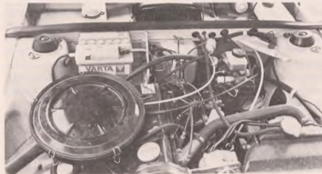
Een blik onder de motorkap van de alcohol Passat. De verschillen zijn niet zichtbaar met uitzondering van het extra benzine-tankje voor koudstarten
