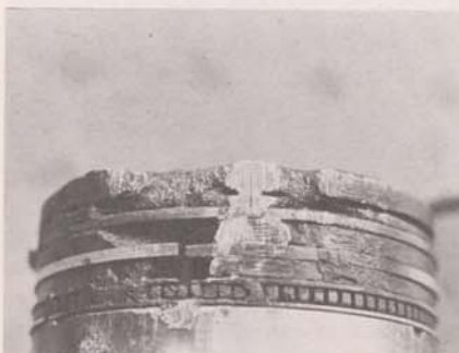
Schade die kan ontstaan wanneer te lang met „pingelende” motor wordt doorgereden
