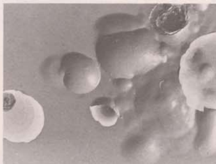
Blaasvorming in het lakwerk. Grote kans hierop bestaat wanneer oudere auto op de verkeerde manier wordt overgespoten. Beschadiging van het plaatwerk door een verkeerde voorbewerking waardoor de roest van binnenuit optreedt. (Putroest)
