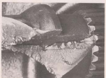
Gebroken aandrijfvas, eveneens door overbelasting
