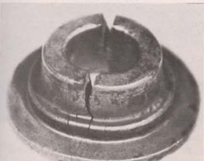
Dit was de boosdoener: materiaalfout in veerschotel, door de breuk van de schotel kon de klep naar beneden schieten
