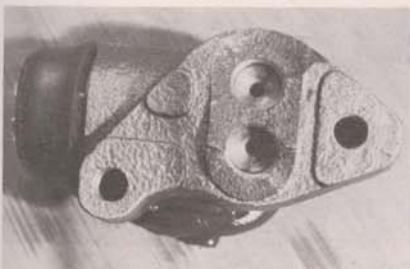
Gebroken wielremcilinder, breuk bij de nippelaansluitingen. Oorzaak: materiaalfout
