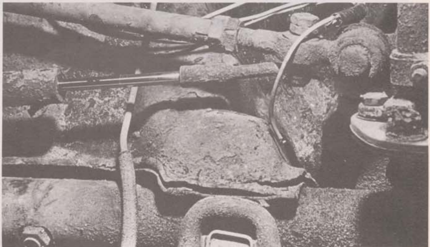
Nog een voorbeeld van slechte schade-reparatie: een gerichte voorkop van een VW 1200, bij het vooraslichaam op meerdere plaatsen gescheurd
