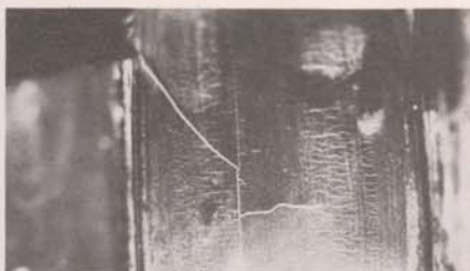
Weer een geval van overbelasting, ontstaan als gevolg van doorrijden met een uitgelopen lager (krukas hoofdlager-tap)
