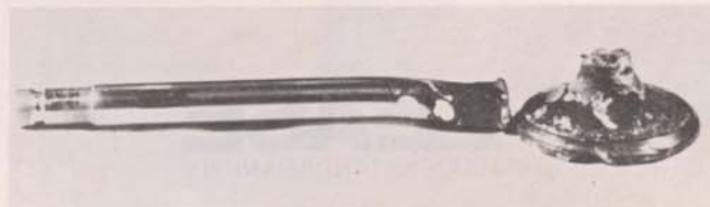
Deze kon 't niet helpen: gebroken uitlaatklep, fout wordt vastgesteld en garantieclaim toch toegekend
