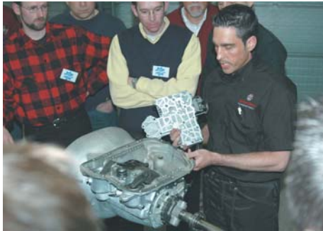
De theorie in de praktijk: stapje voor stapje neemt Niel Speetjens, ook wel Doctor Trannie, een Chrysler-bak uit elkaar, en benoemt hij alle onderdelen...
