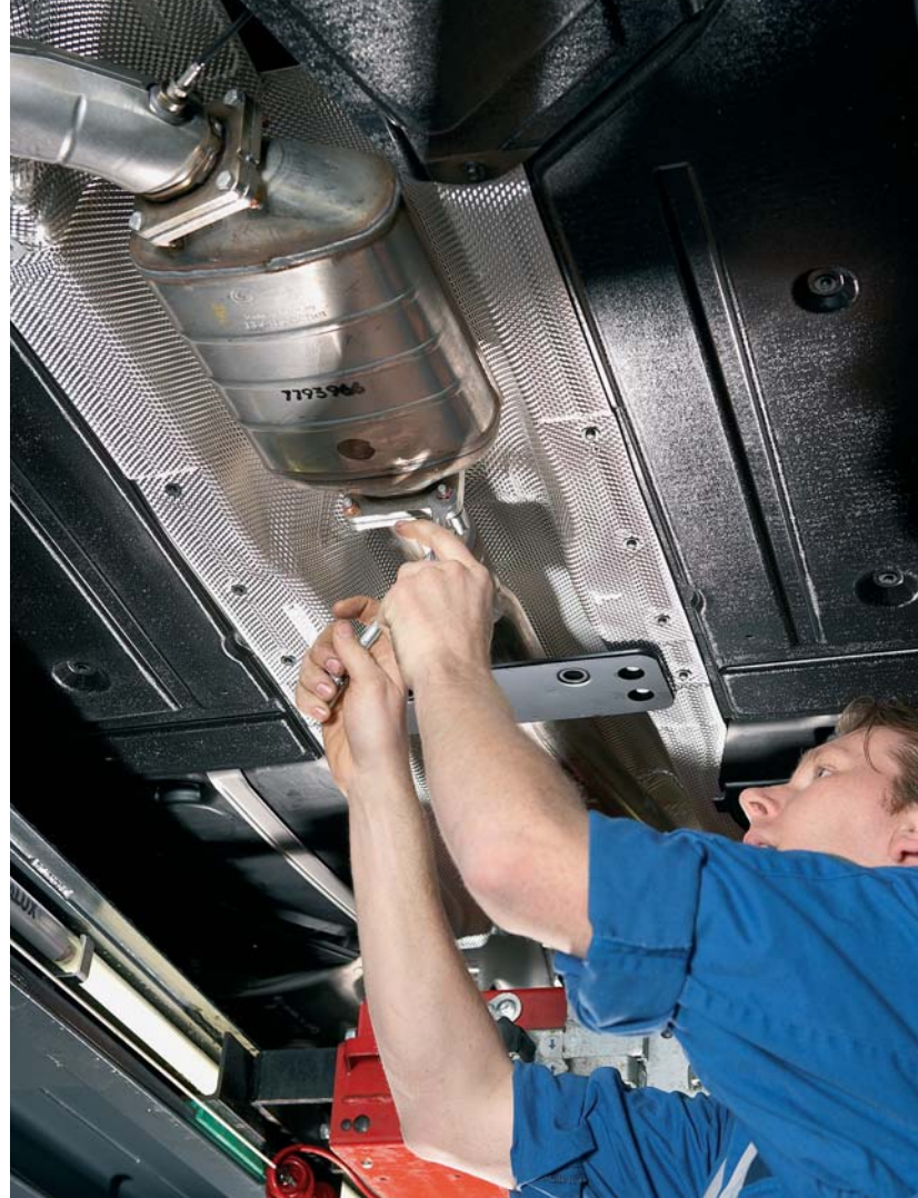
De werking van katalysatoren en filters kan op termijn fors beïnvloed worden door de gebruikte oliesoort. Naarmate zich meer verbrandingsresten afzetten slijbt het uitlaatsysteem dicht en neemt de werking van reinigingssystemen af. Foto: Jan Liefink
