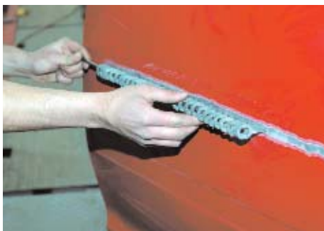
Rivierenland-plaatwerker Ben heeft een reeks trekplaatjes op het Skoda-portier gelast en monteert een trekstang.
