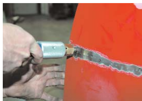
Als hij ten slotte nog enkele opbollende puntjes heeft vlakgegloeid, is het portier klaar voor de voorbewerking.
