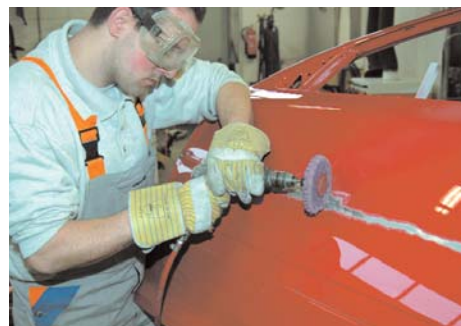
Goed, en dan staat er nog een kleiner deukje, iets schuin op de lange horizontale. Dus maakt Ben ook daar het portier kaal.
