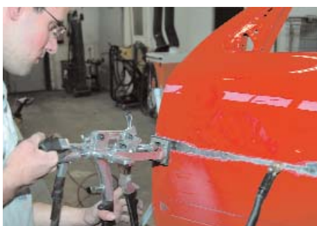
De laatste ongerechtigheden werkt Ben bij met de minipuller.
