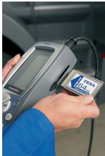
Met een aangepaste Flash-Card en diagnosekabel kan de Axone 2000 Truck ook voor personenauto's worden ingezet. Handig als de truckwerkplaats ook onderhoud verricht aan personenauto's en kleine bestelauto's.
