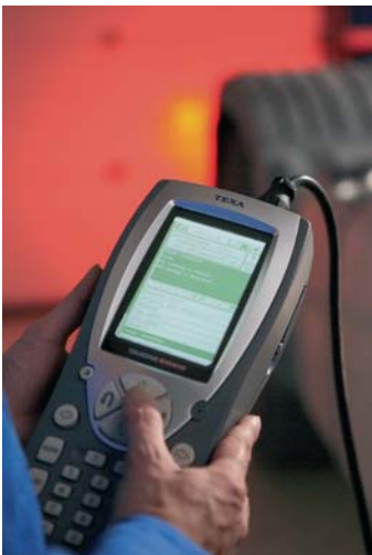
De tester stuurt desgewenst actuatoren aan, óók als de motor niet draait. Even de remlichten checken? Dan geef je de tester opdracht het relais van de remlichten te bekrachtigen. Zo houdt de monteur niemand van z'n werk.
