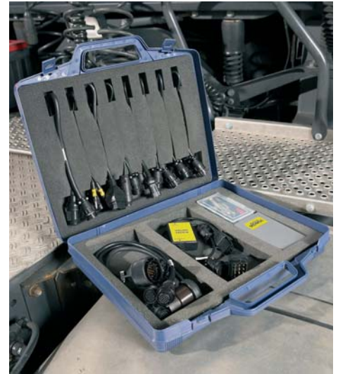
De trucktesters worden compleet geleverd met universele diagnosekabel, OBD-kabel, multiplexer kabel en vele merkspecifieke diagnosekabels. Zo kun je meteen 'universeel' aan de slag. Zelfs kabels voor Wabco en Knorr ontbreken niet.
