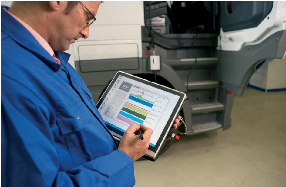
Bij de Navigator Mobile wordt gebruik gemaakt van een diagnose-interface die daadloos via Bluetooth communiceert met een PC (in dit geval een touchscreen tabloïd notebook).
