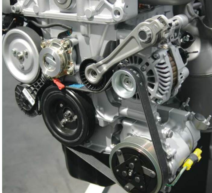
Slimme spanner van 21 torderende imbusstaafjes.
