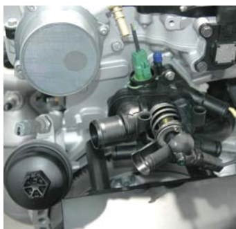
Tot nu toe alleen bekend uit de topklasse: thermostaat met verwarmingselementje. Daarmee kan het motormanagement afhankelijk van de motorbelasting de koelwatertemperatuur regelen.
