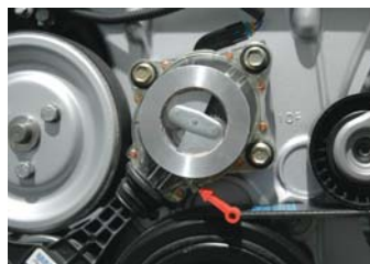
De waterpompoelie (links) aangedreven door een verplaatsbaar wrijvingswiel. Door aan het rode lipje te trekken spant de veer zich en komt het wrijvingswiel los van de poelie en de poly-V-riem. Na vervanging van de poly-V-riem niet vergeten het lipje terug te zetten!
