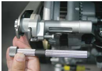
Slimme spanner van 21 torderende imbusstaafjes.
