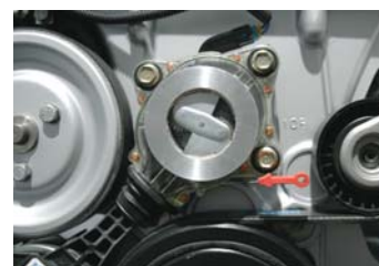
De waterpompoelie (links) aangedreven door een verplaatsbaar wrijvingswiel. Door aan het rode lipje te trekken spant de veer zich en komt het wrijvingswiel los van de poelie en de poly-V-riem. Na vervanging van de poly-V-riem niet vergeten het lipje terug te zetten!
