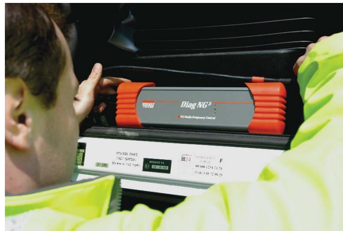
De VCI wordt aangesloten op de diagnoseaansluiting van de truck, deze stuurt de data draadloos naar de diagnosecomputer.
