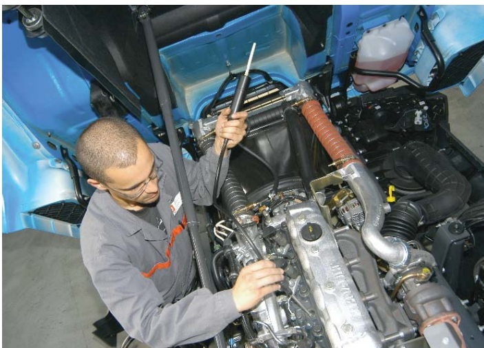
De endoscoop, als optie leverbaar, is voorzien van een camera die zijn beeld draadloos naar het beeldscherm van het diagnoseapparaat stuurt.
