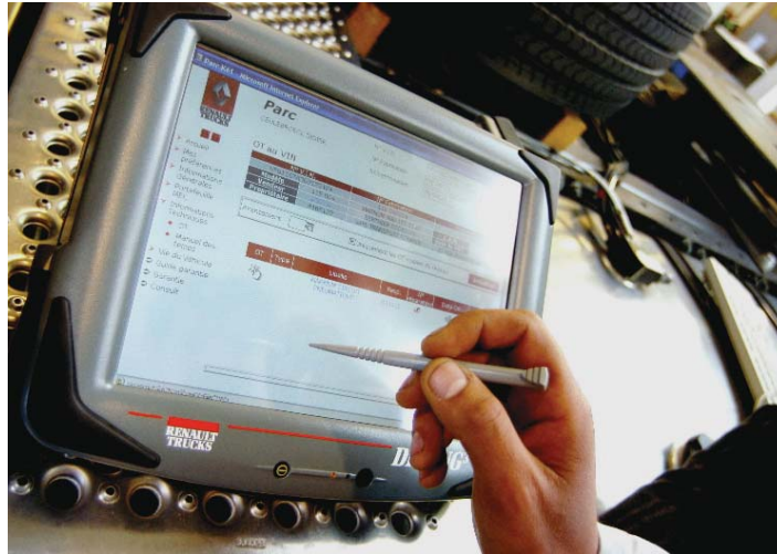
De Diag NG3-diagnosecomputer is een schokbestendige laptop. Via diverse menu's en opties kan de monteur de truck programmeren, diagnosticeren en kalibreren.
