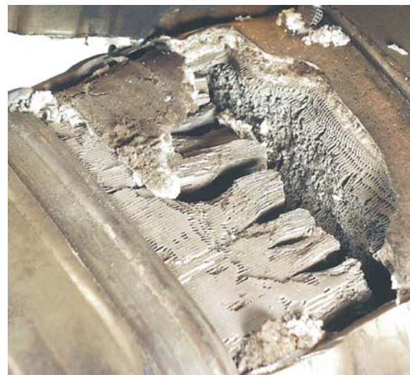
Gesmolten katalysatorbed door defecte bougie of verstuiver.
