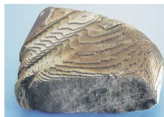
Gesmolten katalysatorbed door defecte bougie of verstuiver.
