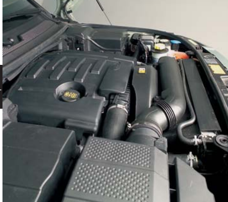
Land Rover deelt deze TDV6 common rail diesel met onder meer de Jaguar S-Type 2.7D en de Peugeot 607 2.7 V6 HDiF.
