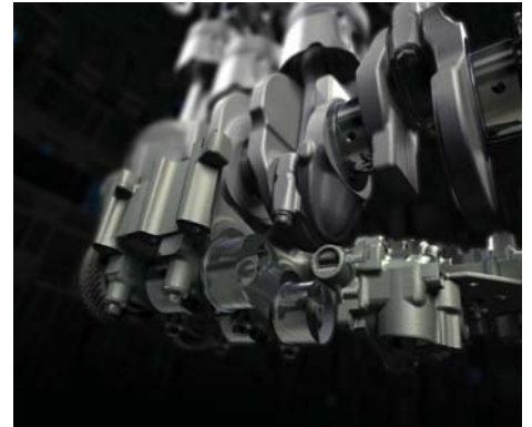
Alleen de sterkste tweeliter heeft balansassen onder de krukas, direct aangedreven met een tandwiel aan vliegwieltzijde op de krukas, om met name trilling en geluid bij hoger toerental te dempen.
