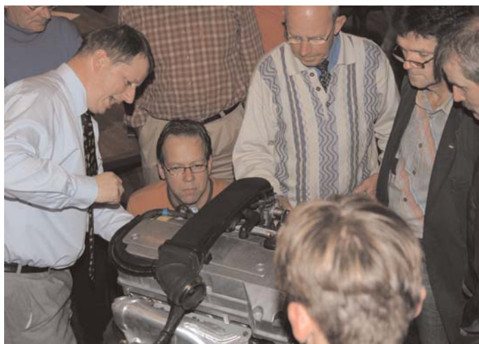
Auto-aardgas specialist Gert-Jan Rap toont de details van een bifuel Mercedes motor met aardgasinjectoren in de kop en benzine-injectoren in het spuitstuk. Over belangstelling van de ATC-ers heeft hij geen klagen.
