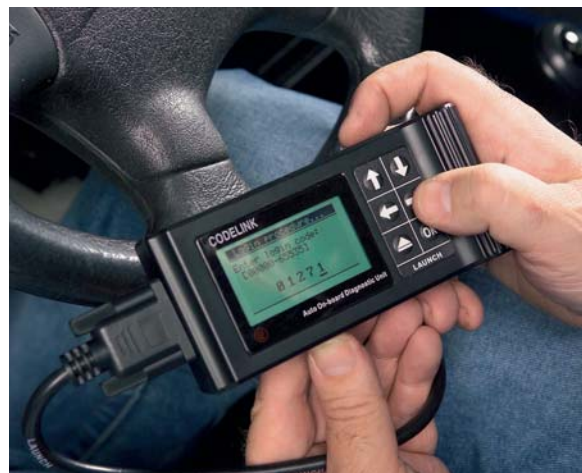
Interessant is de Codelink. Deze leest en wist foutcodes, brengt de datastream in beeld en is behulpzaam bij het programmeren van sleutels.
