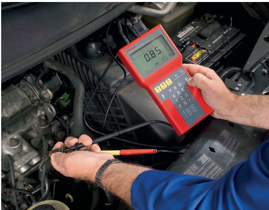
De STS-600 test sensoren op weerstand, spanning en frequentie en is ook in staat sensorsignalen naar de ECU te simuleren. Onnodige vervanging van dure sensoren wordt hiermee voorkomen.
