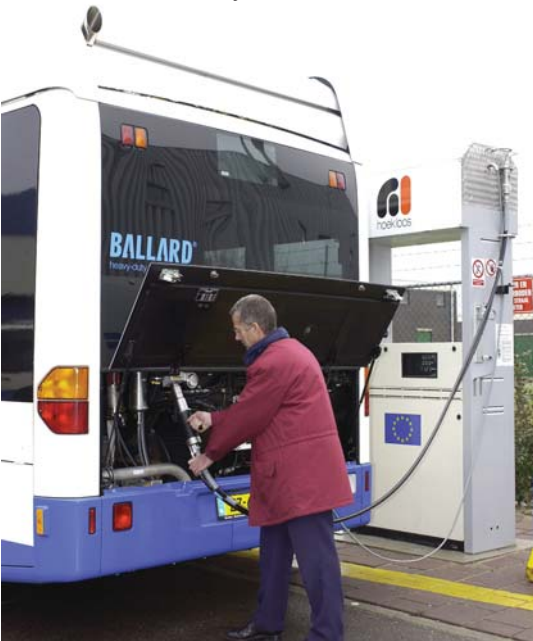
Tanken geschiedt voor iedere rit, de bussen worden dus leeg gestald. Het aansluiten van de slang heeft veel overeenkomsten met LPG. Alvorens te vullen leest het systeem eerst de data uit en controleert het de druk en temperatuur van de installatie.
