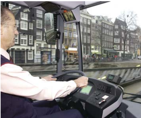
Aan de infrastructuur rondom de bestuurdersplaats is zo weinig mogelijk veranderd; accelereren, remmen, schakelen, alles is gelijk aan de diesel. Wel zijn er aan het instrumentenpaneel een aantal controlelampjes toegevoegd inclusief een scherm dat informeert over de huishouding van het brandstofcelsysteem.
