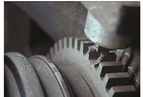
Bij nadere analyse vallen de twee beschadigde tanden op de tandkrans op. Bij hoge snelheid beïnvloedt dit het sensorsignaal en de ECU slaat alarm. Blijf dus altijd alert op mechanische schade.
