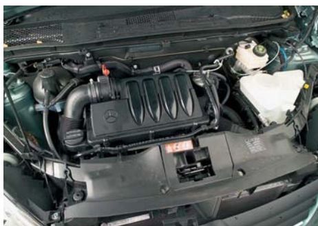
Bij een frontale botsing schuift de motor van de A-klasse onder de chassisbalken weg. De technicus heeft van deze motorplaatsing weinig gemak.
