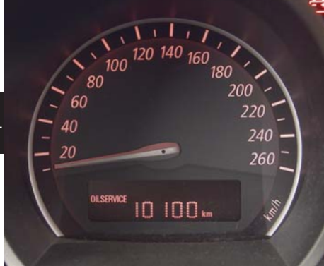
De boordcomputer geeft aan wanneer de Z4 aan de volgende oliebeurt toe is.
