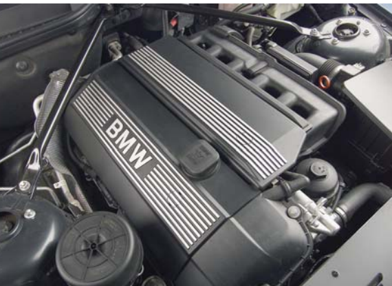
Onder de motorkap een 2.5 of 3.0 liter zescilinder met traploos dubbel-Vanos systeem. De 2.5 liter is gekoppeld aan een vijfbak, de 3.0 liter aan een zesversnellingsbak.
