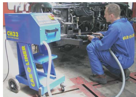
Na vervorming is uitdrogen van het aluminium vereist om de oorspronkelijke materiaaleigenschappen te behouden.
