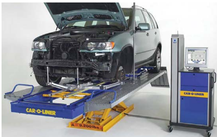
De Vision dirigeert de schadehersteller via LED's naar het meetpunt. Voortdurend kijken op het beeldscherm is dus niet nodig.
