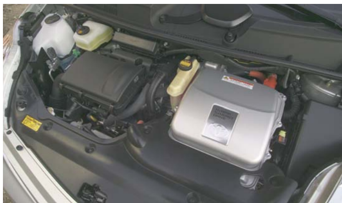
Op zich al een wonder van compacte bouw, de 1.5 met 16 kleppen, twee nokkenassen en variabele klepbediening (links in de motorruimte), een 50 kW elektromotor en een generator (rechts), met ertussen nog een planetair tandwielstel voor de aandrijfregeling.
