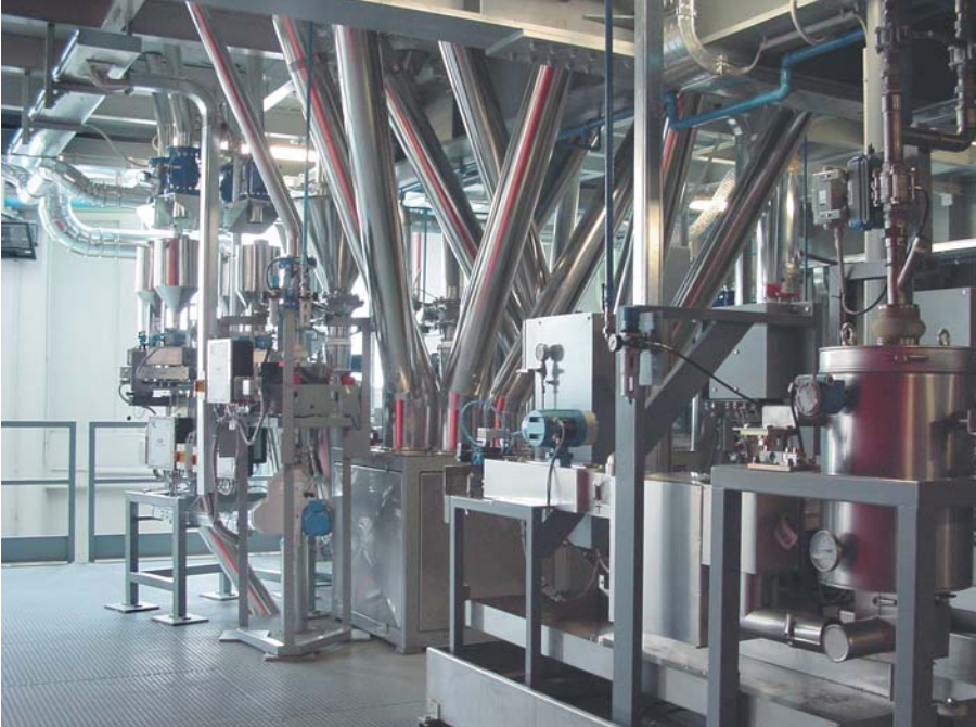
Hier gebeurt het dan, de aanvoermachines op de voorgrond voeden een extruder erachter, die er een streng bandenrubber uit perst. Direct na de extruder meet een computerstation de belangrijke mechanische eigenschappen van het rubber, waarop de werking van de CCM-installatie gecorrigeerd kan worden.
