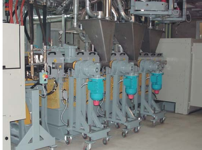
Hier gebeurt het dan, de aanvoermachines op de voorgrond voeden een extruder erachter, die er een streng bandenrubber uit perst. Direct na de extruder meet een computerstation de belangrijke mechanische eigenschappen van het rubber, waarop de werking van de CCM-installatie gecorrigeerd kan worden.
