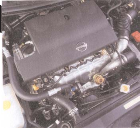
De 2.2 DCT diesel is een moderne unit met common-rail injectie, intercooler en variabele turbo. Hij is gekoppeld aan een 6-bak.
