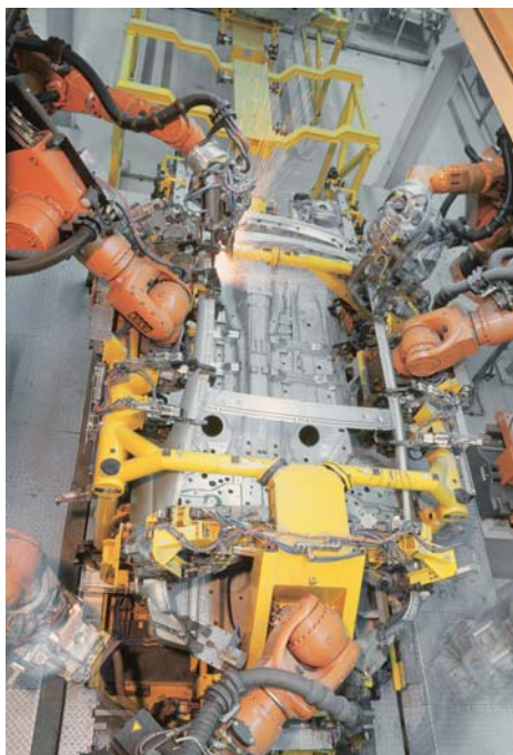
Las-lijmverbindingen voor een grotere stijfheid, een betere botsbestendigheid en een stillere carrosserie. In dit geval aan de zijramen, volautomatisch aangebracht door een robotstation.
