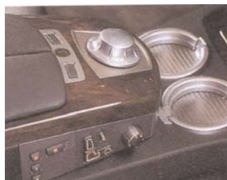
De ronde knop doet dienst als een soort computermuis en loodst de bestuurder door zo'n 550 functies. Opzij van de armsteun is de stoelverstelling ondergebracht.
