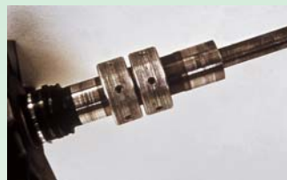
De turbine-as is door vuil in de olie diep gegroefd
