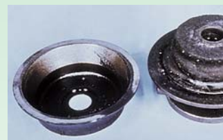
De ingedikte olie zet zich vast in het lagerhuis en blokkeert de olie-afdichtingen
