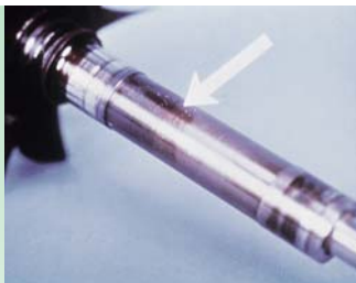
De astemperatuur kan tot 400°C oplopen, de smeeroilie oxydeert
