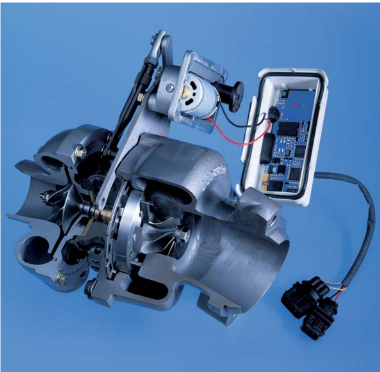
De V8 BMW diesel heeft twee turbo's met elektrisch verstelbare leidschoepen. Door het elektronisch aansturen van de elektromotor worden de leidschoepen nauwkeurig en snel vermeld afhankelijk van de motorbelasting en het toerental.
