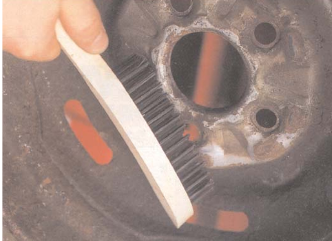
Vuil geeft veel onnauwkeurigheden tijdens het balanceren. Reinig regelmatig de balanceeras en het aanlegvlak van machine en velg.
