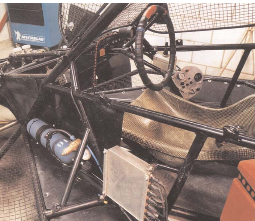
De Fast & Speed crossauto kan worden uitgerust met sequentiële schakeling. Aan de rechterzijde naast het stuur is de joy-stick gemonteerd, aan de linkerzijde de ECU en de fles met perslucht die de regelpneumatiek van de schakelwals/schakelassen van luchtdruk voorziet. Vergeet de coureur te schakelen dan gaat de bak dit automatisch doen.
