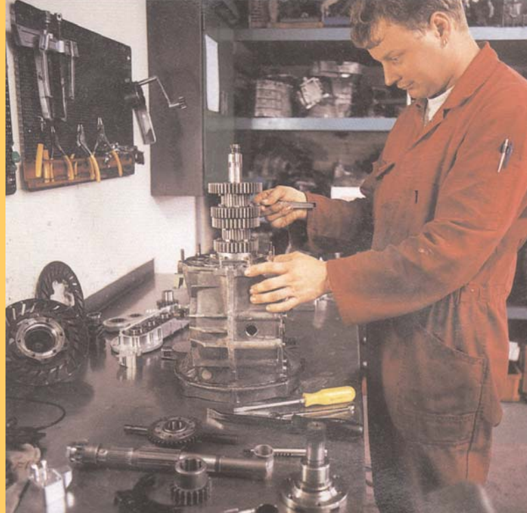
Iedere bak wordt, voordat deze in de wagen wordt gebouwd, nauwkeurig gecontroleerd en eventueel geschikt gemaakt voor sequentiële schakeling. Hier wordt de axiaalspeling gecontroleerd. Tevens is de schakelwals te zien die voor de sequentiële schakeling nodig is en het deksel dat over de aftakking voor de vierwielaandrijving wordt geplaatst.
