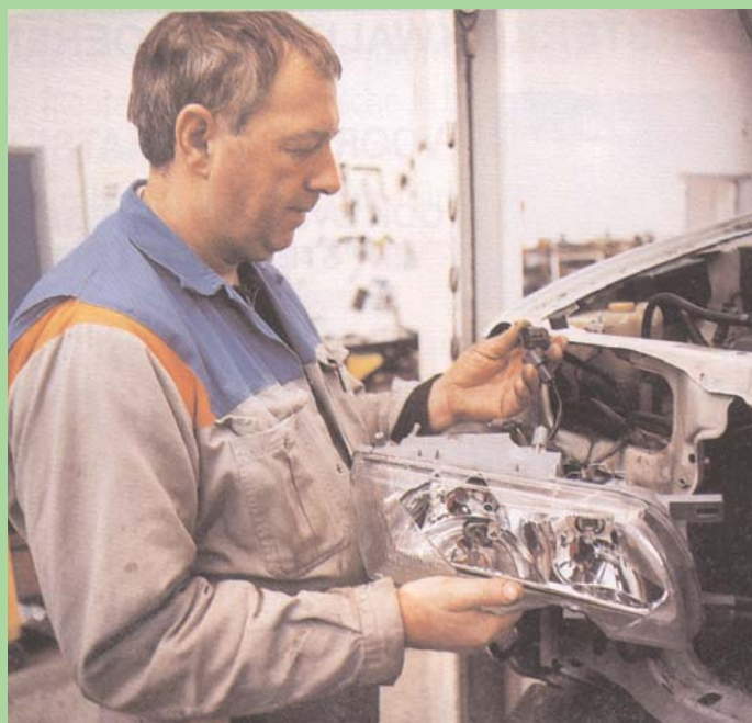
Kapotte of beschadigde delen zoals deze koplamp-unit worden in hun geheel verwijderd en vervangen. Repareren is in veel gevallen geen rendabel alternatief.
