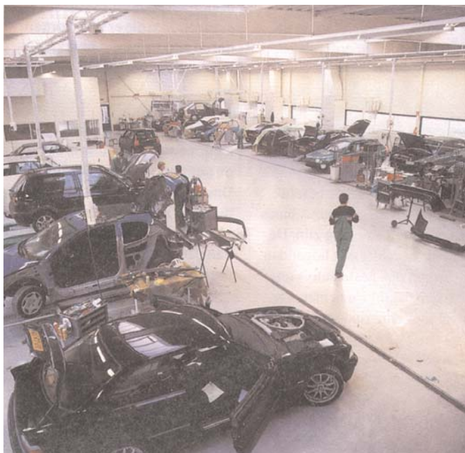
In de werkplaats zijn in principe 22 werkplekken ingericht, waarvan tien met een hefbrug. Dit laatste om medewerkers de mogelijkheid te geven onder alle omstandigheden een comfortabele werkhoogte te realiseren.
