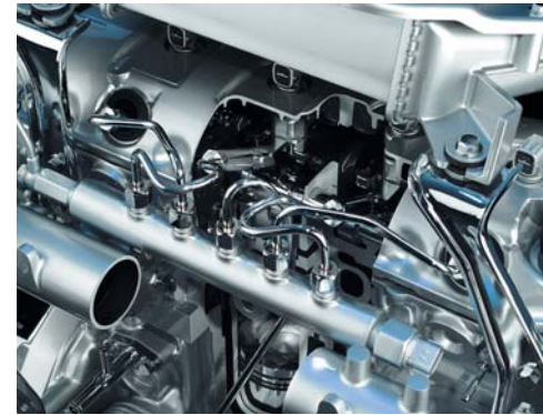
Pas vorig jaar introduceerde Nissan in de Almera voor het eerst directe diesel-injectie, met roterende pomp, nu stapt men bij de Primera en de X-Trail al over op een common rail systeem.
