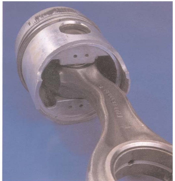
Een lekke koppakking kan ernstige gevolgen hebben zoals blijkt uit deze verbogen drijfstang van een dieselmotor. Oorzaak: waterslag. De krachten die optreden bij dergelijke calamiteiten zijn enorm.
