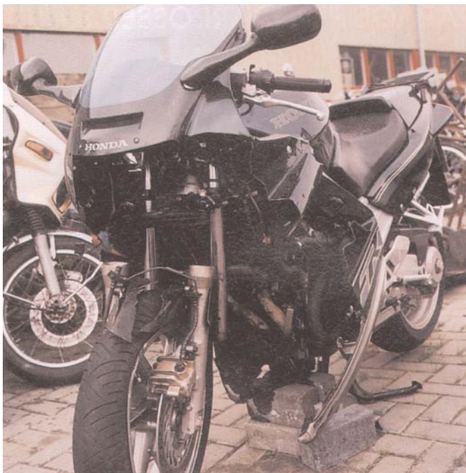
Een treffend voorbeeld van een frame dat niet meer kan worden gered. De klap is zo groot geweest dat de complete voorvork is afgerukt. In dit geval heeft zelfs meten geen zin meer
