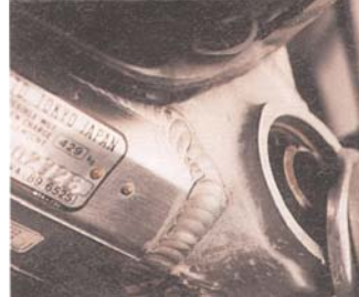
Aluminium frames kunnen niet worden gericht. Dit is een aardig voorbeeld van welke schade er kan ontstaan aan een dergelijk frame. De las is gescheurd en niet meer te repareren, dus rest het slopen van de motorfiets.
