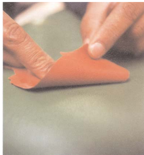
Om in een gerepareerd dashboard of in kunststofbekleding de juiste structuur terug te krijgen wordt een speciaal malletje gemaakt.
