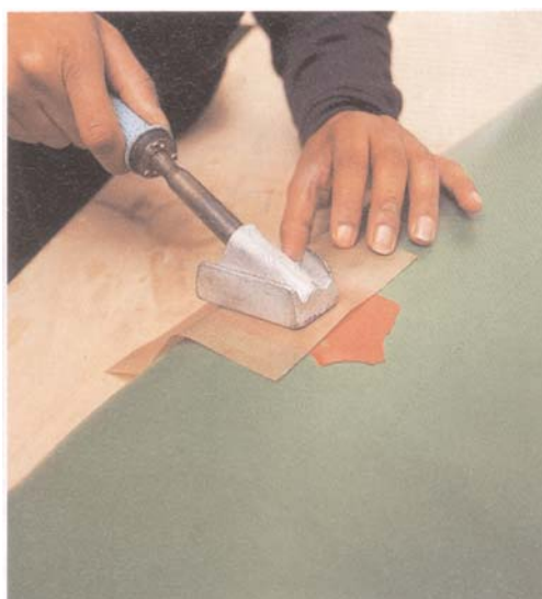
Het malletje wordt op de gerepareerde plek gelegd met een 'strijkijzer' verhit. Op die manier wordt de materiaalstructuur overgebracht.
