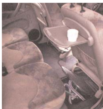
Beide voorstoelen hebben een tafeltje in de rugleuning. In de vloer zijn ruime bergvakken aangebracht.
