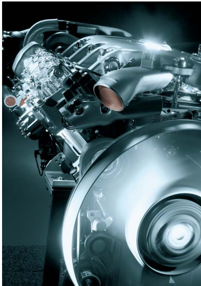
De 12 liter MAN Euro 3 motor heeft vier kleppen per cilinder en een gekoelde EGR. De kleinere motoren hebben een inwendige EGR en een turbo met by-pass klep. Opvallend is dat er respectievelijk een elektronisch geregelde lijnpomp en een verdelerpomp worden toegepast.
