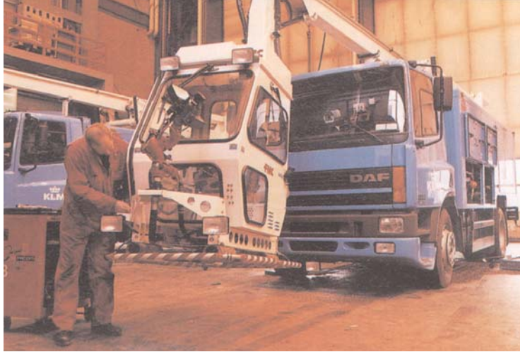
Eén brok staal zo'n vliegtuigtrekker. Een gaatje boren en vervolgens een draadje tappen neemt een hele morgen in beslag.
