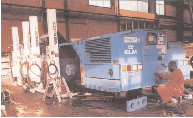
Eén brok staal zo'n vliegtuigtrekker. Een gaatje boren en vervolgens een draadje tappen neemt een hele morgen in beslag.
