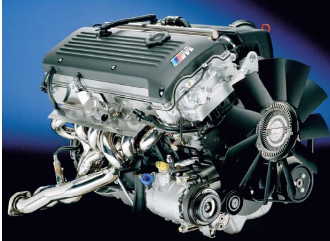
De nieuwe M3 motor is niet alleen buitengewoon sterk, hij is ook buitengewoon soepel omdat de trekkracht al vanaf 1.000 t/min aanwezig is. Het hoogste toerental is 8.000 t/min.
