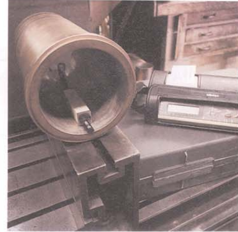
Na het honen wordt met dit apparaatje de structuur van de cilinderwand bepaald. De noodzakelijke pitting 'komt' tot stand tijdens het aanbrengen van de laag tijdens het badproces.
