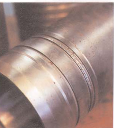
Het aanbrengen van de Lunac 1 laag van 10 µm aan de buitenzijde van de bus zorgt ook voor een betere afdichting. Er zijn aanwijzingen dat hierdoor de invloed van cavitatie een stuk minder zou zijn.
