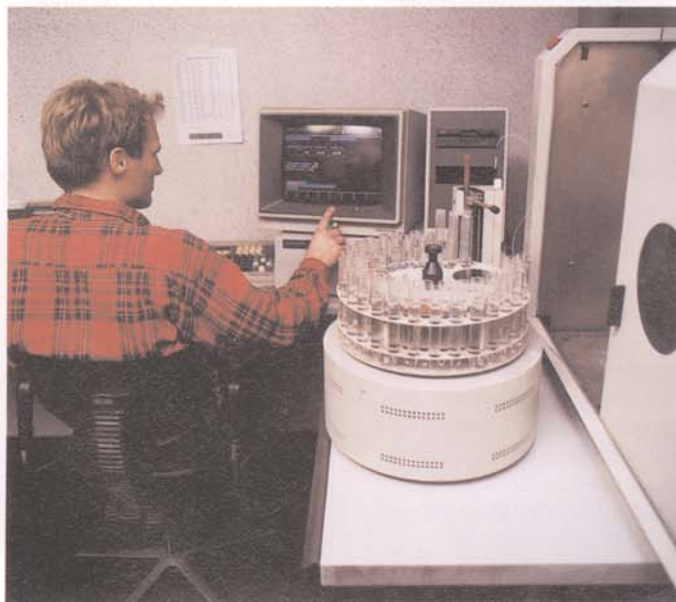
Het bedrijf heeft de beschikking over een eigen laboratorium en dat moet ook wel want het complete procédé is zelf uitgedacht en daarna gepatenteerd. Met deze IC plasmaspectrometer kunnen legeringen worden ontleed tot op elementniveau.
