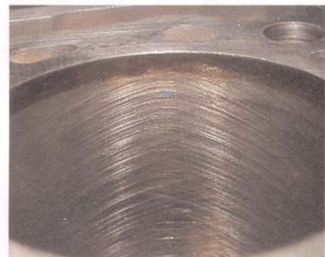
Een racemotor met 5.000 kilometer op de klok vertoont 2 micrometer slijtage, terwijl een onbehandelde motor dan vaak al afgeschreven is (zie ook de grafiek met de gaslek bepaling) omdat de prestaties te veel zijn teruggelopen. De hoonstructuur van de motor is ook nog goed zichtbaar.
