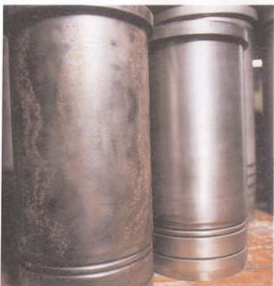
De cilinderbussen van de WKK motoren worden aan de buitenkant voorzien van een Lunac 1 laag. Dit ter bescherming van de bijtende werking tijdens het baden. Hier een kale en een behandelde bus.
