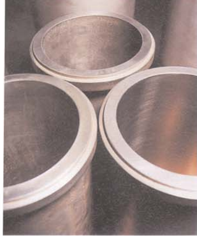
Een onbehandelde (linksvoor), een behandelde (middenachter) en een behandelde plus gehoonde cilinderbus.
