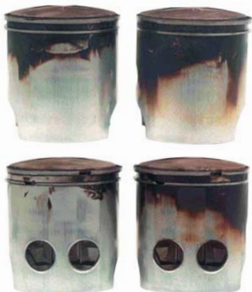
Het benzine additief van Texaco werkt ook bij tweetaktmotoren. Bij deze Yamaha 350 cc tweecilinder kreeg de rechter cilinder benzine zonder additieven terwijl de linker cilinder benzine met Texaco Gasoline Additive Extra toegevoerd kreeg. De bovenste zuigers tonen de uitlaatpoortzijde, de onderste de inlaatkant.
