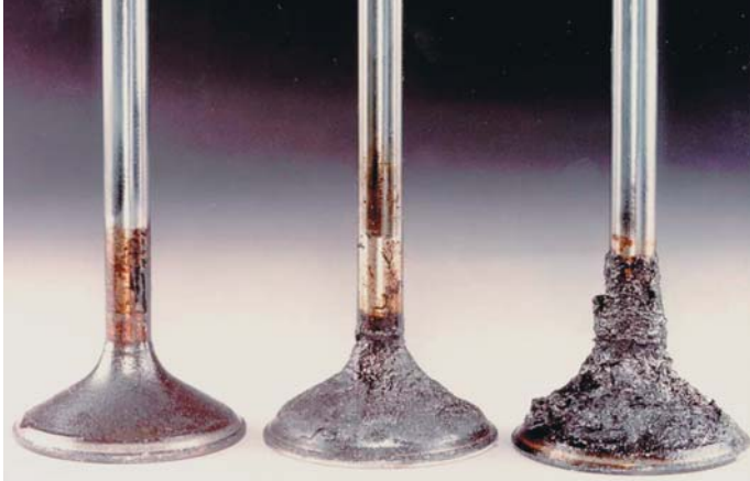
De vervuiling van inlaatkleppen kan zeer ernstige vormen aannemen. Vooral oliedampen en smeeroilie veroorzaken ongewenste aanslag. Een hoogwaardige motorolie kan veel problemen voorkomen.
