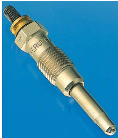
De Beru SR5 gloeibougie met een gloeispiraal en een regelweerstand ingebed in magnesium-oxyde. Het uiteinde (de tip) is tot vier millimeter verschaald.
