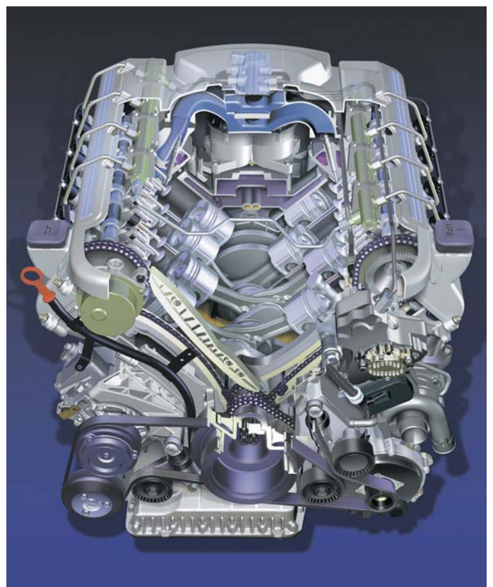
De BMW V8 motor heeft vier kleppen per cilinder en een centraal geplaatste verstuiver. De V-hoek bedraagt 90° en dat geeft ruimte voor het inlaatsysteem. De hogedrukpomp wordt aangedreven door de linker inlaatsnokkenas.
