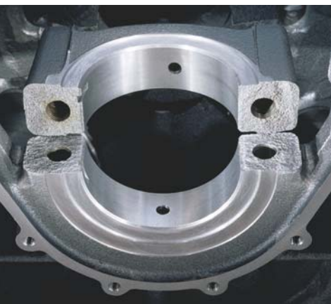
Voor de eerste keer worden ook de hoofdlagerkappen gebroken. Deze techniek zorgt voor een perfecte centering die zo goed dwarskrachten kan opnemen dat met twee bouten kan worden volstaan.
