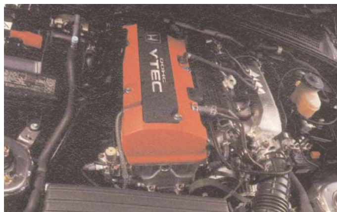
Het hart van de auto, de prachtige lichtmetalen 16V 2.0 liter VTEC met het opvallende rode klepdeksel. Dit sportmotortje draait moeiteloos 9000 t/min.
