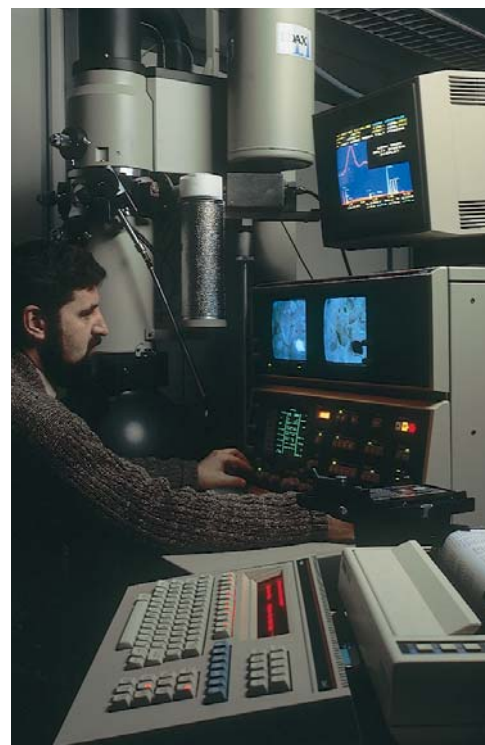
De Scanning Transmission Electron Microscope (STEM) wordt gebruikt om een gedetailleerd beeld te krijgen van de microstructuur van bijvoorbeeld metaal, keramiek en coatings.
