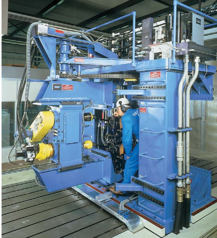
Met DYANA, DYNamic Test and ANALysis System, kan men tegelijkertijd zes van de op de proefbaan gemeten parameters nabootsen. Dat zijn snelheid, aandrijfmoment, verticale- en laterale wielkracht, stuurhoek en verticale wielverplaatsing.
