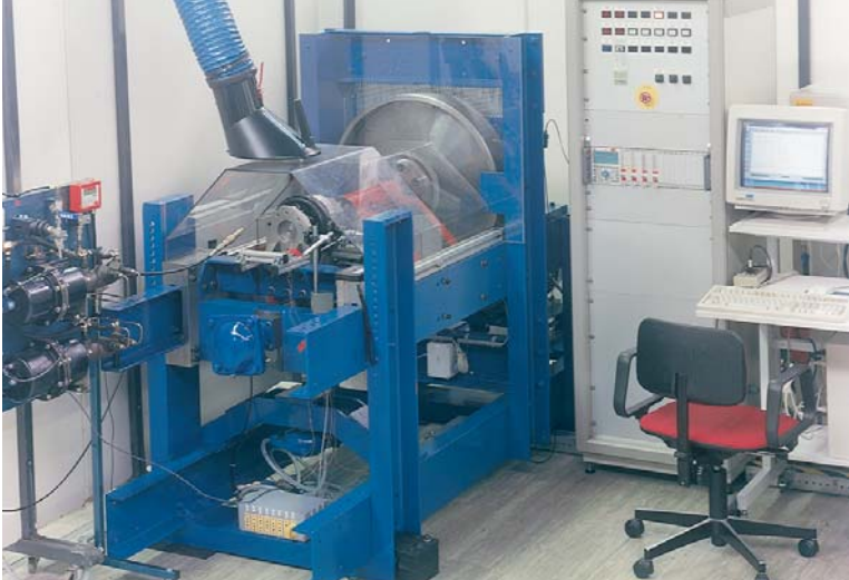
Deze machine heeft de naam Bruce en dat is een afkorting van BRake Unit Concept test Equipment. Hij wordt gebruikt voor onderzoek op het gebied van de ontwikkeling van nieuwe rem/wiellagersystemen, onder meer nieuwe materialen en integratie van remtrommel en wiellager.
