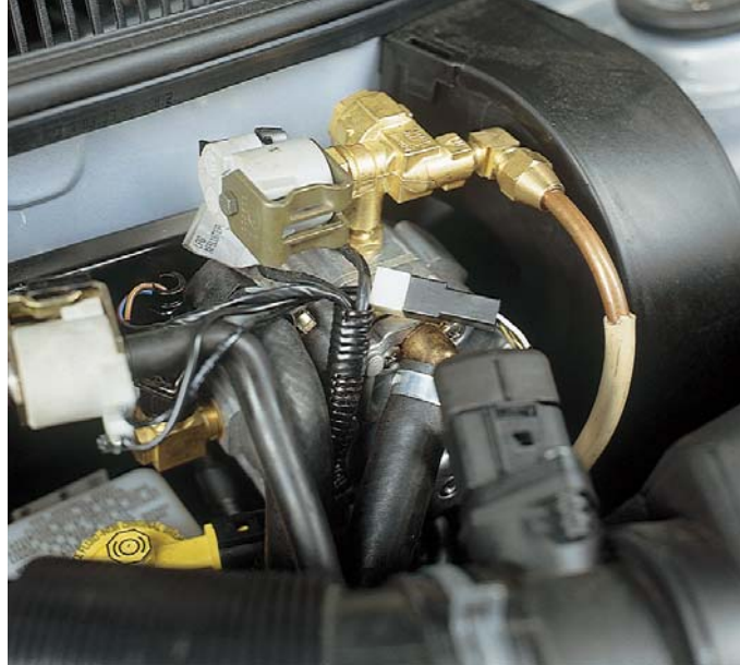
De verdampers/drukregelaar van Necam omvat ondermeer een stappenmotor die het mengsel regelt. De stappenmotor wordt aangestuurd door het in de microprocessor opgeslagen kenveld.
