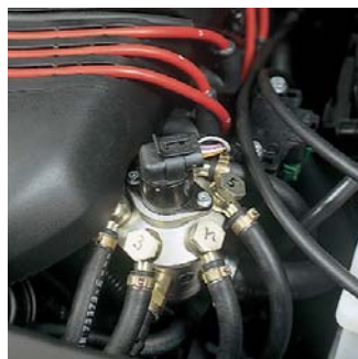
De verdampers/drukregelaar van Necam omvat ondermeer een stappenmotor die het mengsel regelt. De stappenmotor wordt aangestuurd door het in de microprocessor opgeslagen kenveld.
